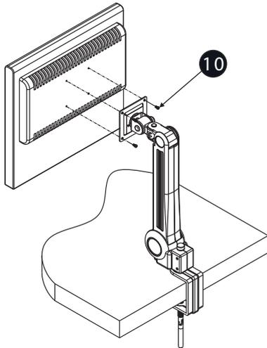
**IV. Befestigung des Halterungswinkels mithilfe der 100x100-mm-Lochschablone**
