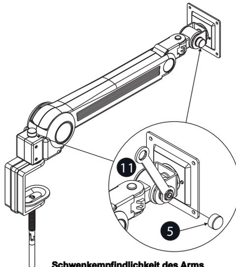
**Schwenkempfindlichkeit des Arms mit dem Schraubenschlüssel (6) testen**
